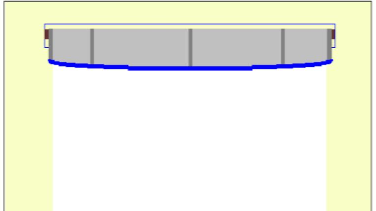
В данном случае начинать наклеивать ленту нужно на средний шов, при необходимости добавляя ленту на соседние швы. Однако следует помнить, что количество ленты на соседних швах должно быть симметричным относительно середины полотна
