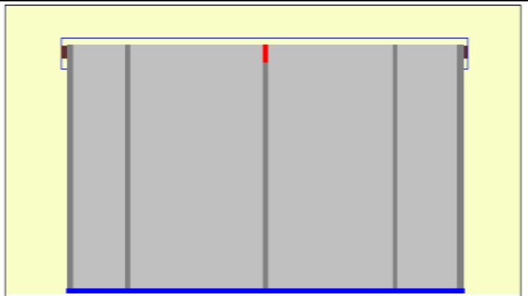
Пример 3 – отсекающая шина провисает по краям
