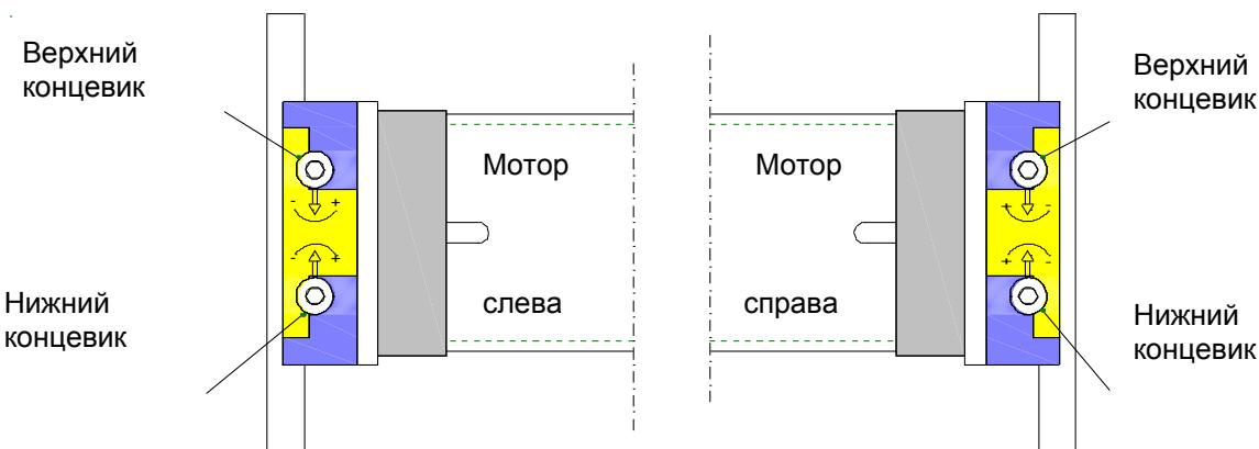
Через предусмотренные на концах корпуса лючки открыт доступ к головке мотора. Эти лючки после настройки выключателя закрываются крышкой.
